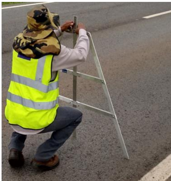
Figura 104 – Medição do afundamento em trilha de roda (ATR) com treliça metálica.
