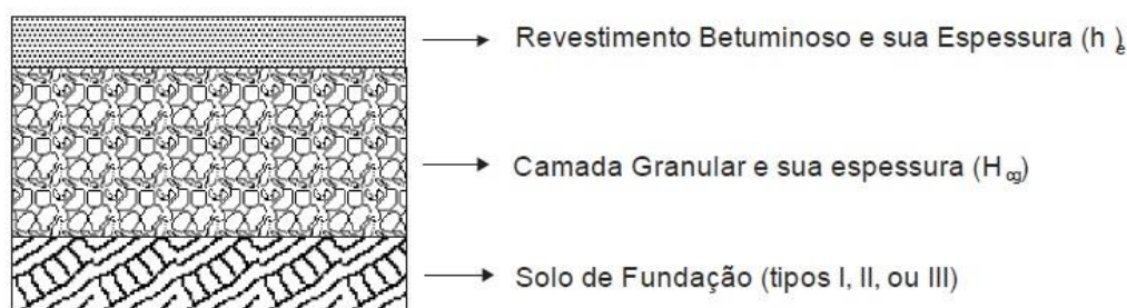
Figura 150 – Estrutura de referência do método TECNAPAV (DNER, 1994).
