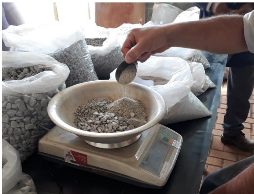
Figura 71 – Pesagem dos agregados na proporção da composição granulométrica (41% de brita 0, 24% de brita 1 e 35% de pó de pedra) para composição de corpos-de-prova.
