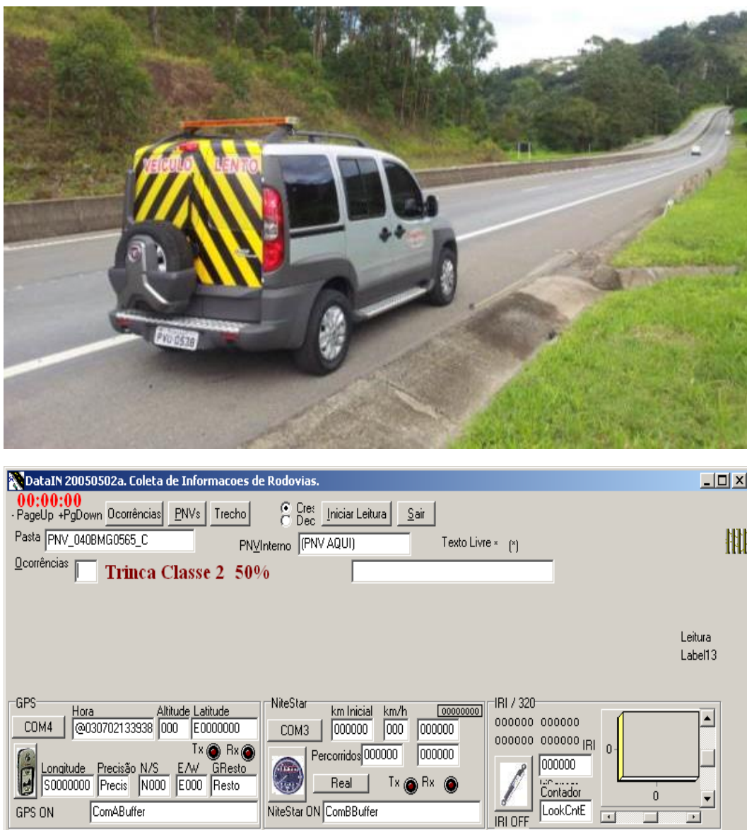
Figura 23 - Laboratório Móvel instrumentado e sinalizado e software (DataIN – Enggeotech, 2003) para integração e sincronização dos instrumentos utilizados para realização do levantamento.
