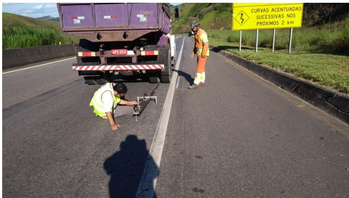
Figura 106 – Ensaio com uso da viga Benkelman.
