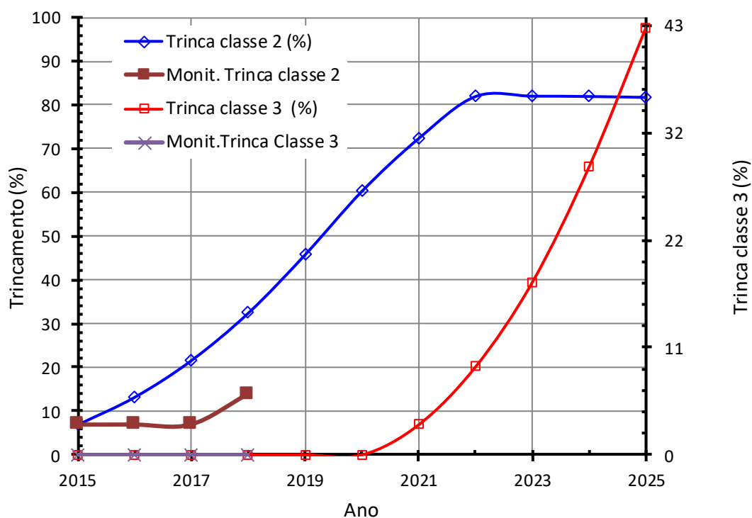
Figura 208 – Previsão e monitoração do trincamento total (%) e trincas classe 3 (%) x tempo (anos).
