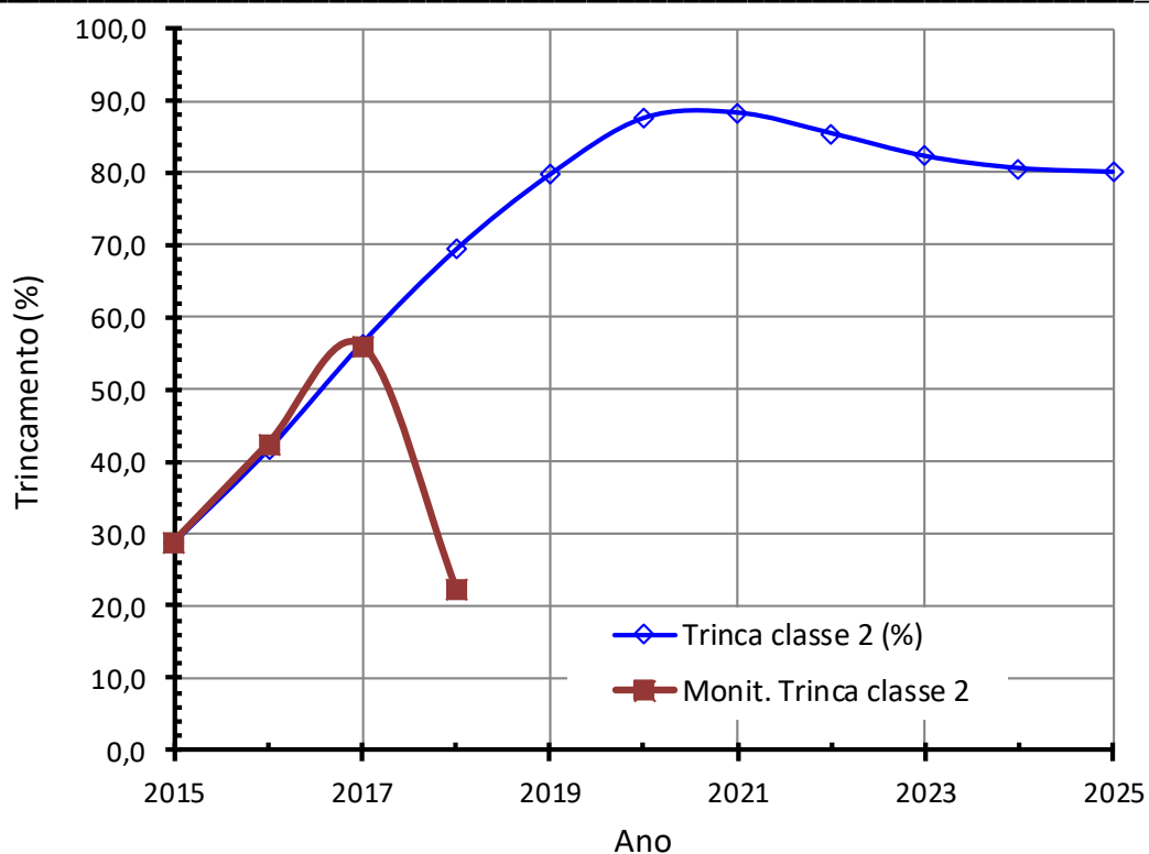
Figura 182 – Previsão e monitoração do trincamento total (%) x tempo (anos).
