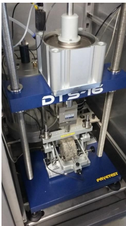
Figura 88 – Equipamento de carga repetida ajustado pronto para ensaio de compressão diametral.
