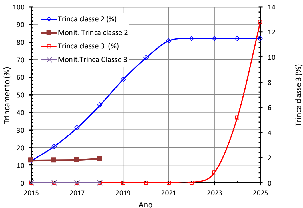
Figura 198 – Previsão e monitoração do trincamento total (%) e trincas classe 3 (%) x tempo (anos).
