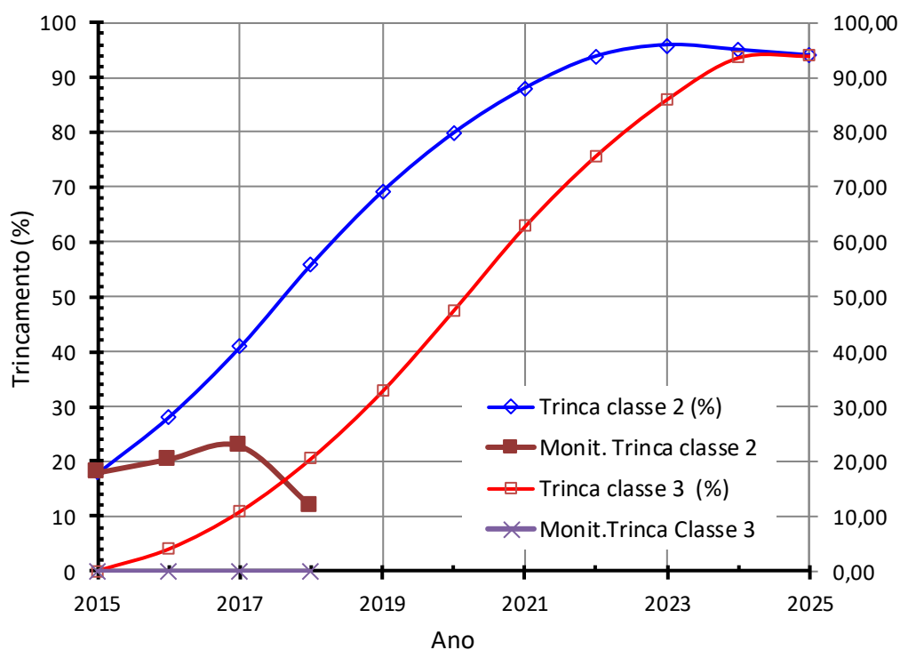
Figura 193 – Previsão e monitoração do trincamento total (%) e trincas classe 3 (%) x tempo (anos).
