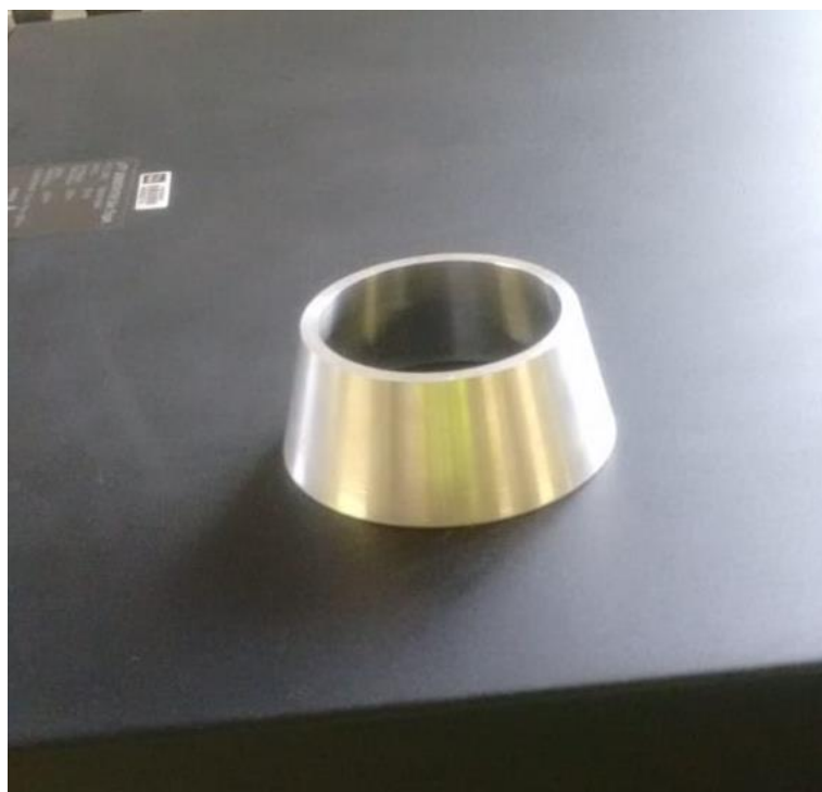
Figura 3 - Forma tronco cônica para ensaio de absorção de água.
