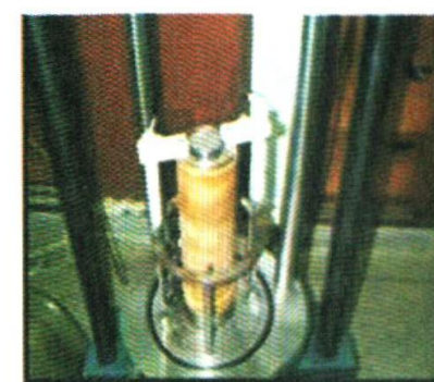
Montagem dos LVDTs sobre o top cap na câmara triaxial
