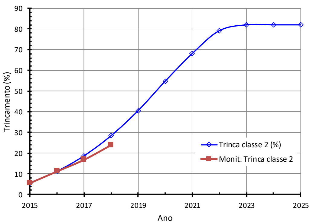
Figura 187 – Previsão e monitoração do trincamento total (%) x tempo (anos).
