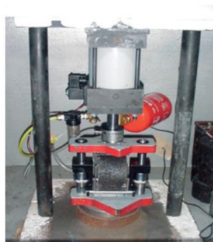
Figura 81 – Exemplos de equipamento para ensaio de compressão diametral de carga repetida (Bernucci et al. , 2006).
