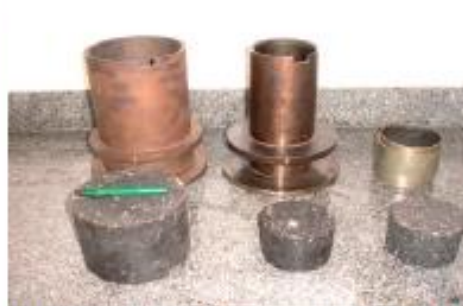
(h) Corpos-de-prova Superpave (diâmetros 150 e 100mm) e corpo-de-prova Marshall (100mm) e respectivos moldes
