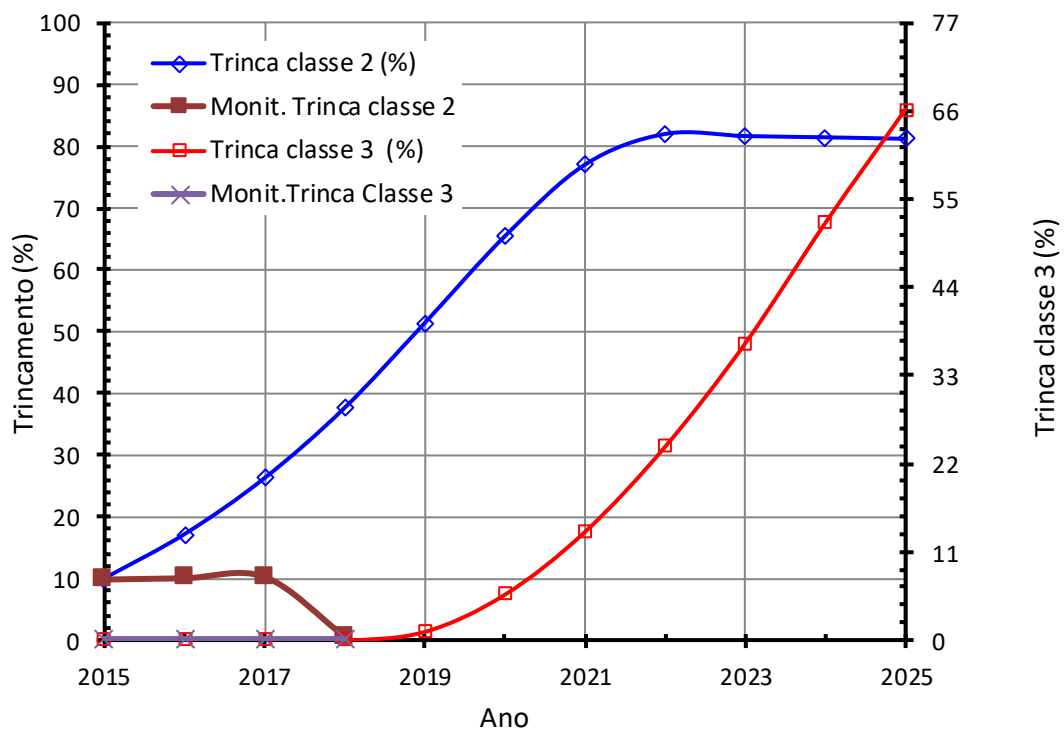
Figura 218 – Previsão e monitoração do trincamento total (%) e trincas classe 3 (%) x tempo (anos).
