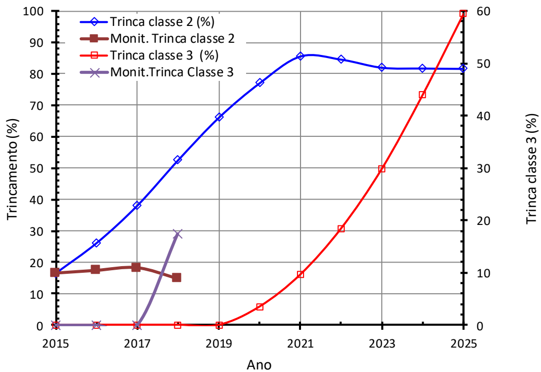
Figura 228 – Previsão e monitoração do trincamento total (%) e trincas classe 3 (%) x tempo (anos).
