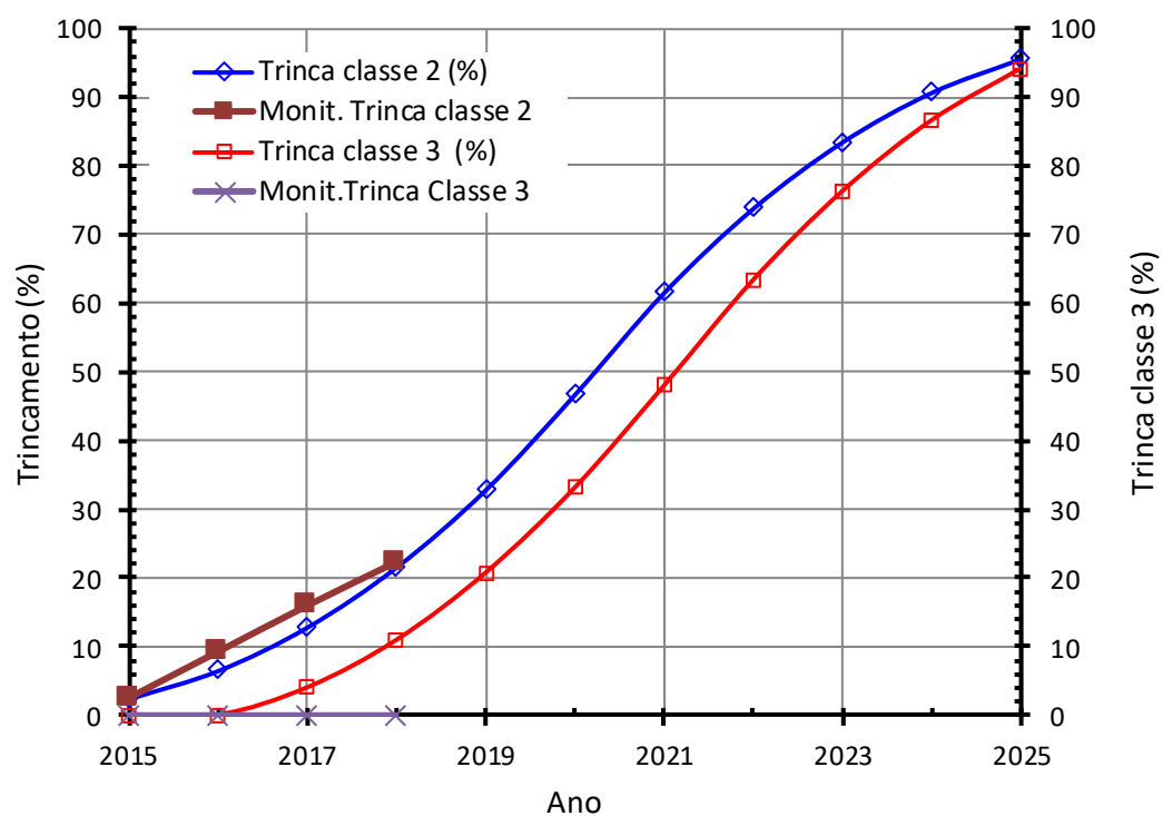
Figura 273 – Previsão e monitoração do trincamento total (%) e trincas classe 3 (%) x tempo (anos).
