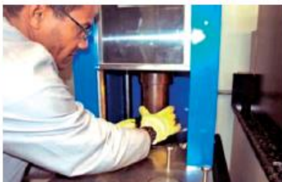
(f) Ajuste do corpo-de-prova para compactação
