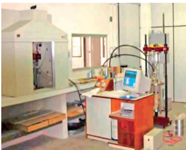
Figura 81 – Exemplos de equipamento para ensaio de compressão diametral de carga repetida (Bernucci et al. , 2006).
