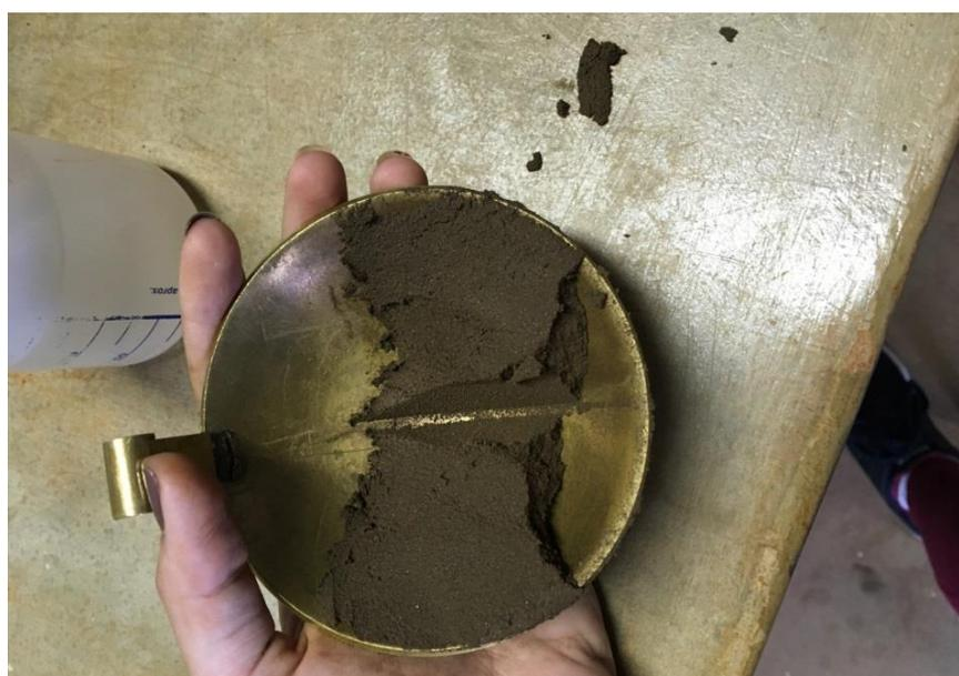
Figura 9. Detalhe da tentativa de utilização do Aparelho de Casagrande
