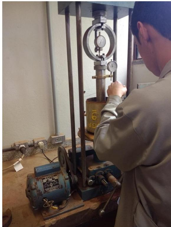
Figura 17. Detalhe da montagem da etapa de penetração – ensaio ISC (CBR)
