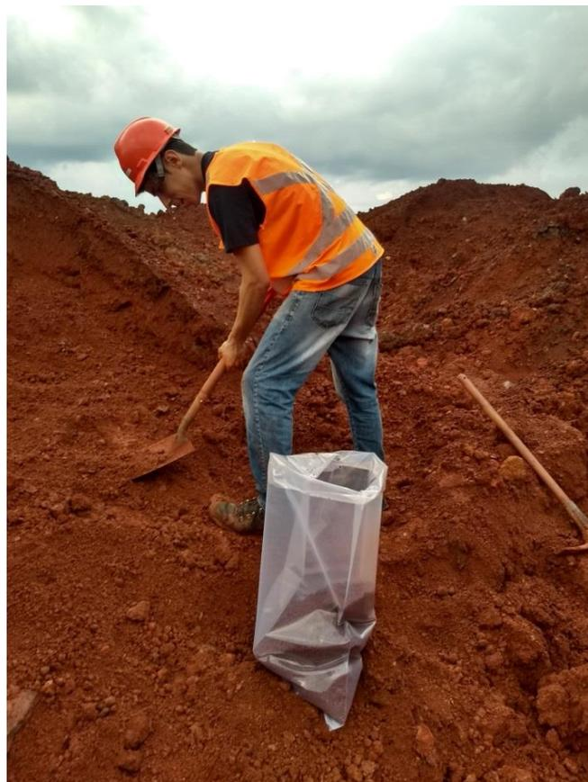
Figura 2. Vista do procedimento da coleta de amostras deformadas do solo S1
