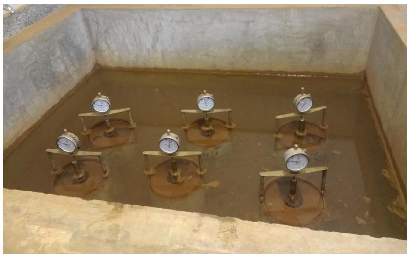
Figura 16. Vista dos CP's imersos (ensaios de expansão) – ensaio ISC (CBR)
