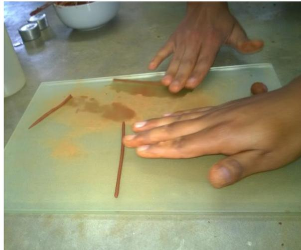
Figura 10. Vista de parte do procedimento para determinação do limite de plasticidade
