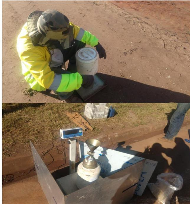
Figura 2.9 - Ensaio de densidade *in situ* pelo método frasco de areia na camada de base
