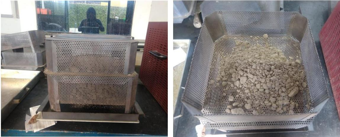
Figura 2.16 - Amostra depois do processo de extração de betume
