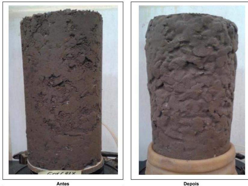
Figura 2.8 - Ensaio de Módulo de resiliência na composição M7.
