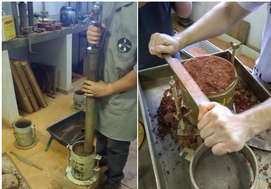
Figura 2.6 - Ensaio de compactação para determinação dos parâmetros ótimos da compactação.
