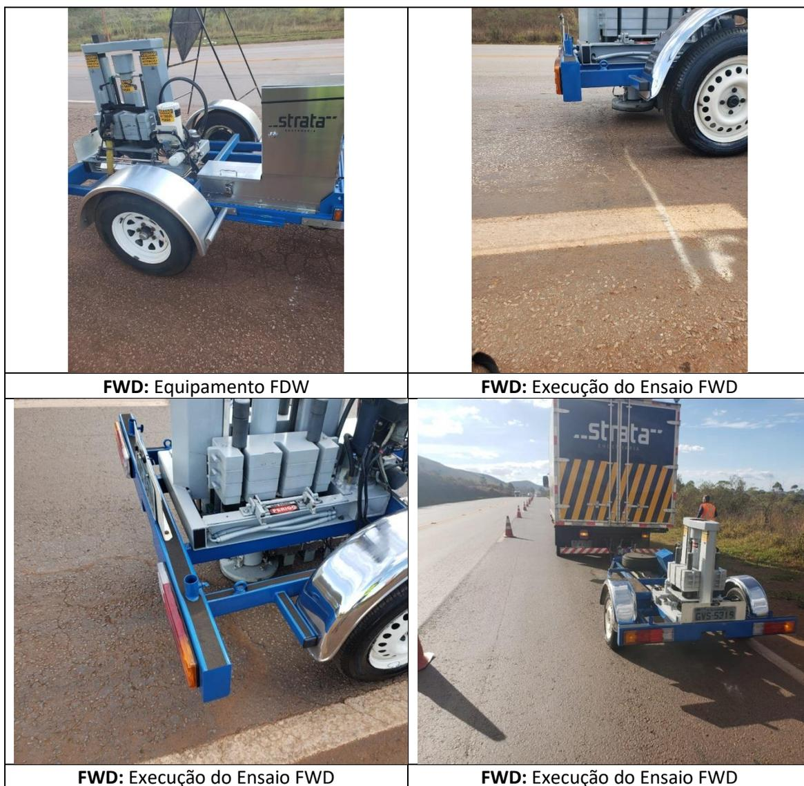
Figuras 3.17 – Processo de medição com o FWD
