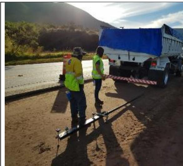
**Base:** Ensaio Viga Benkelman
