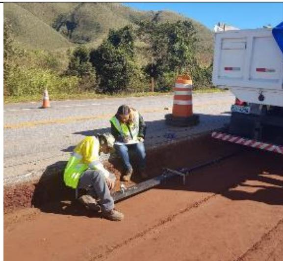
**Sub-base: Ensaio Viga Benkelman**
