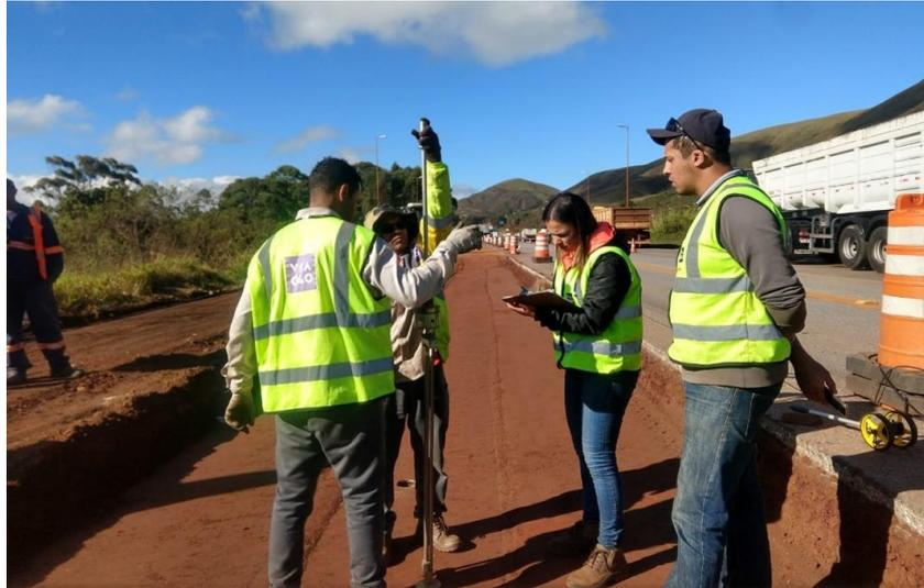
Figura 2.11 - Ensaio de DCP no subleito.
