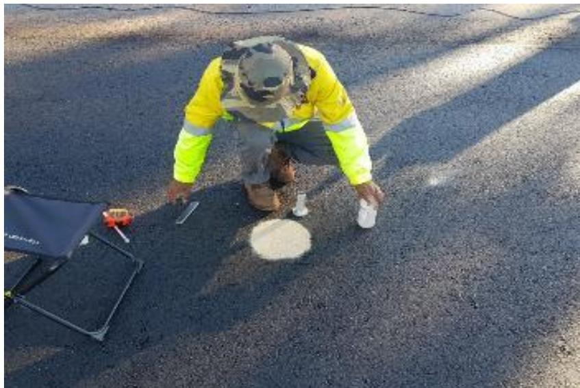
Figura 2.13 - Ensaio de mancha de areia realizado na pista experimental
