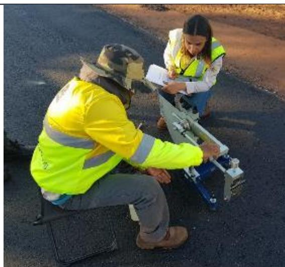
**Revestimento:** Ensaio do Pêndulo Britânico
