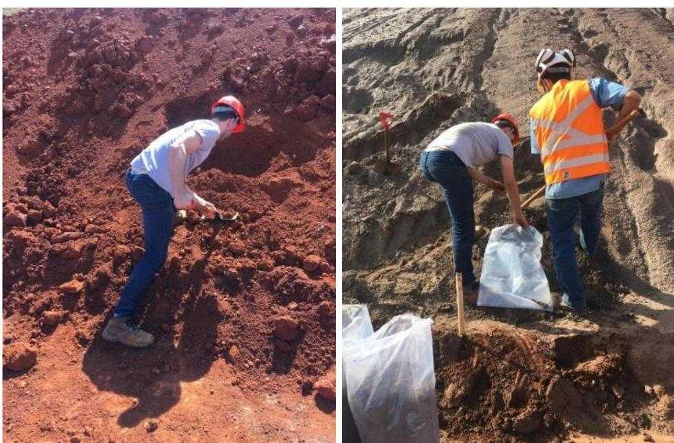
Figura 2.1 – Coleta de estéril e rejeito proveniente da extração de minério de ferro.
