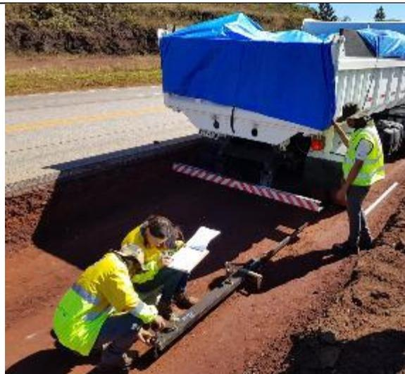
**Regularização do Subleito:** Ensaio de Viga Benkelman
