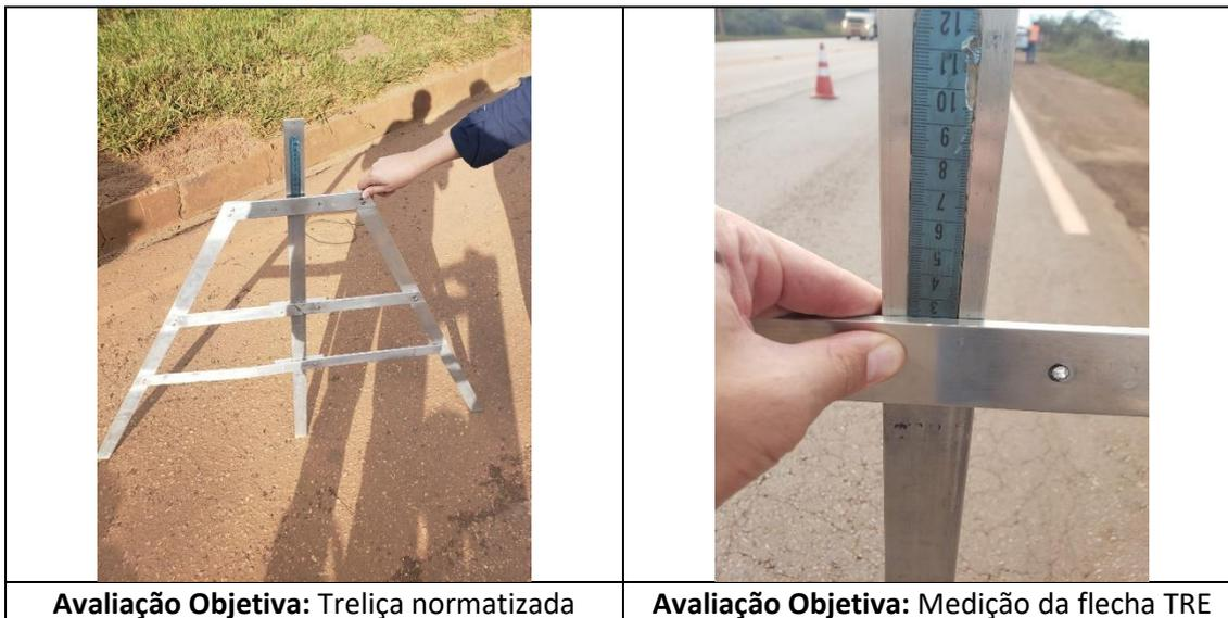
Figuras 3.15 – Medidas de deformações permanentes da trilha de roda.
