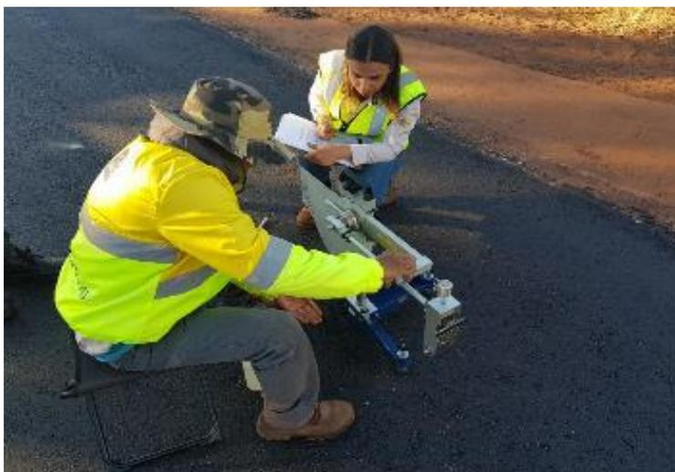
Figura 2.14 - Ensaio de pêndulo britânico no trecho experimental
