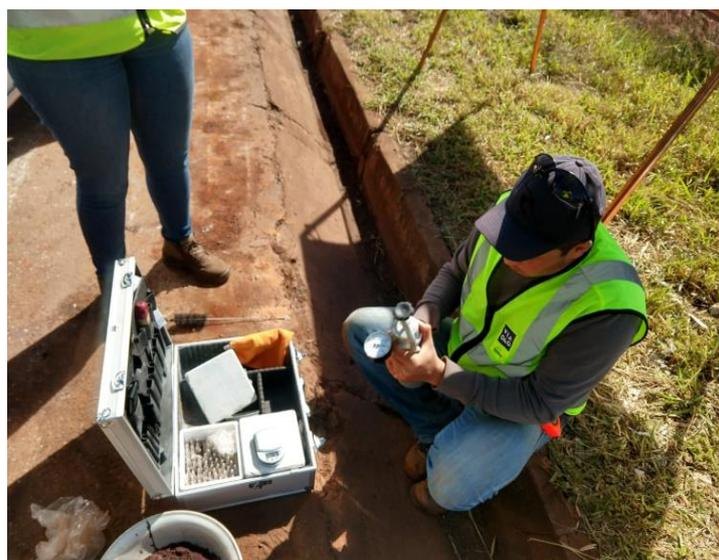
Figura 2.10 - Determinação da Umidade pelo método do *Speedy*.
