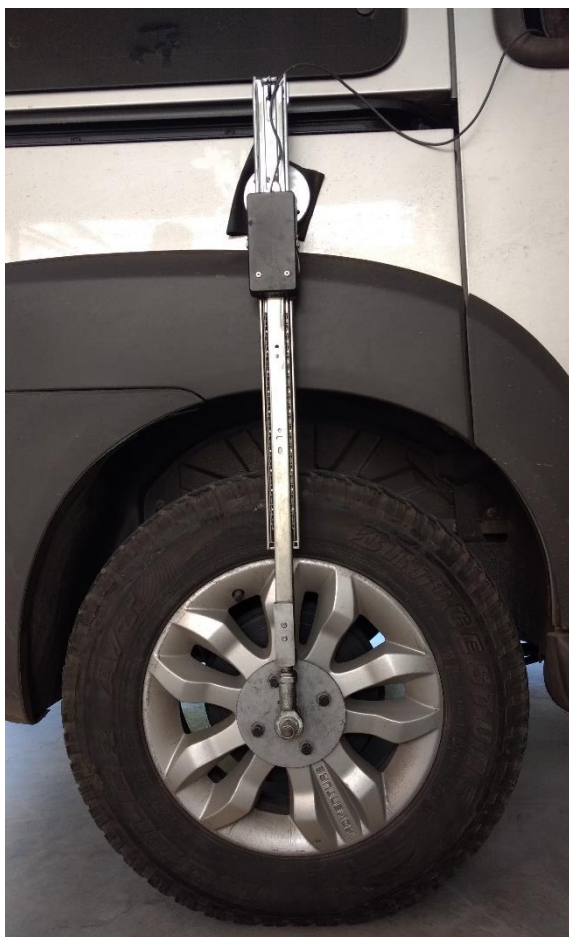
Figura 4 – Sistema medidor do tipo resposta (SMITR).
