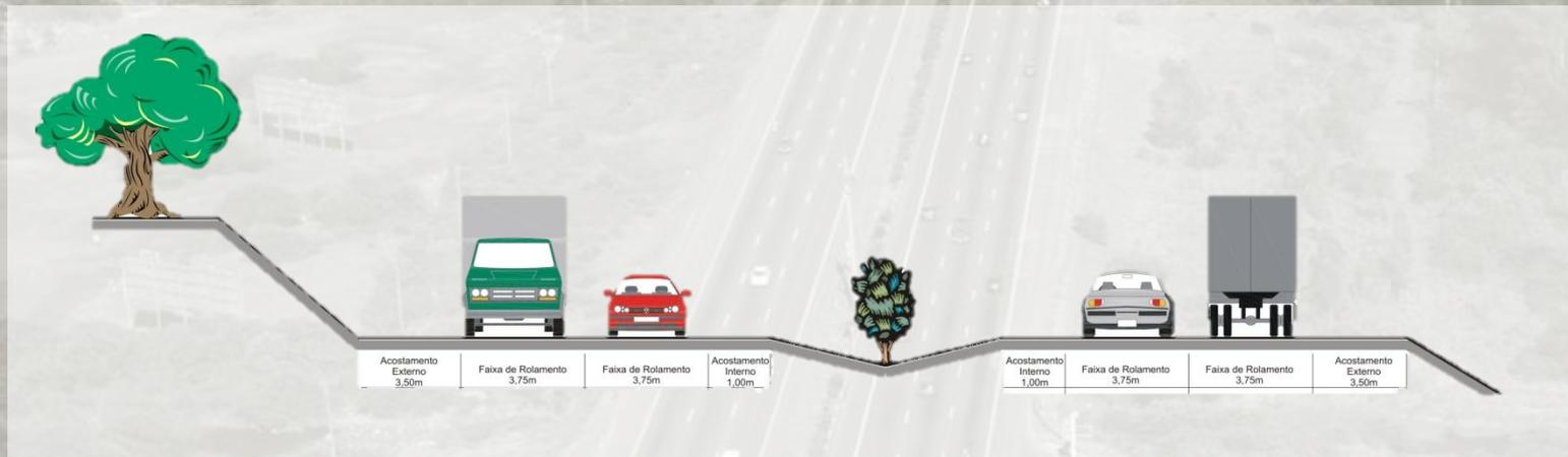
**Depois:** três faixas de rolamento de 3,75 metros, faixa de segurança interna com 2 metros e acostamento externo com 3 metros
