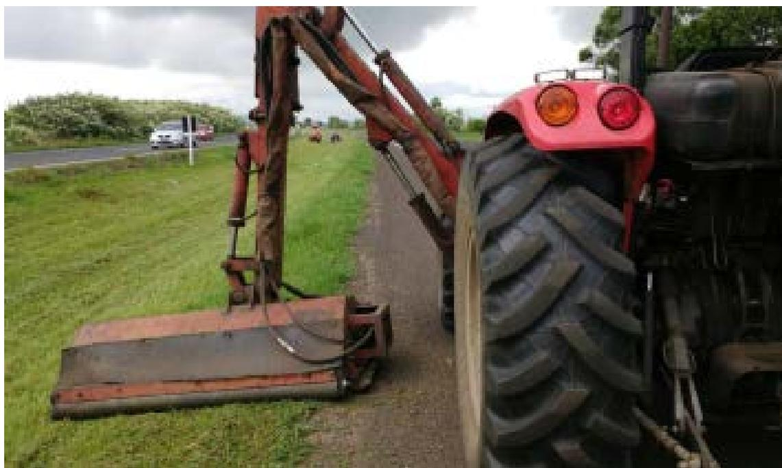
*Figura 75 – CONSERVAÇÃO/MANUTENÇÃO – ROÇADA MECANIZADA*
