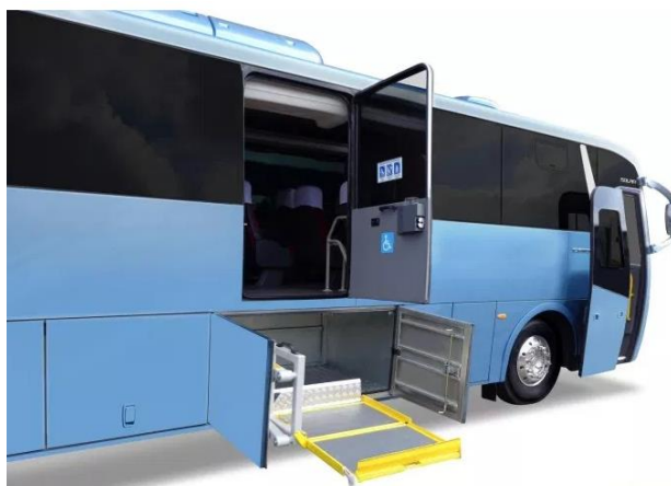
Figura 16: veículo com plataforma elevatória veicular
