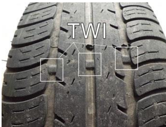
Figura 2: exemplo do indicador TWI em pneu
